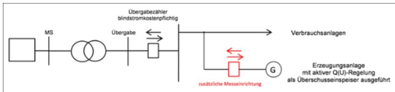
Abbildung 2: SNN-Messkonzept / Zähleranordnung
